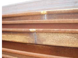
鋼矢板溶接継ぎ
