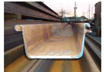
サイレントコーナー加工
